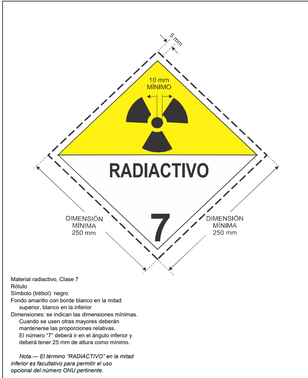
Figura 5-30. Material radiactivo, Clase 7, rótulo para contenedores grandes
